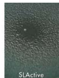
Abb. 4: Nachweis der superhydrophilen Eigenschaft von SLActive. Die Luftblasen, die zwischen dem Wasser und der SLA-Oberfläche eingeschlossen sind, erzeugen die Brechungen unter dem Wassertropfen.
