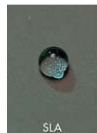
Abb. 4: Nachweis der superhydrophilen Eigenschaft von SLActive. Die Luftblasen, die zwischen dem Wasser und der SLA-Oberfläche eingeschlossen sind, erzeugen die Brechungen unter dem Wassertropfen.
