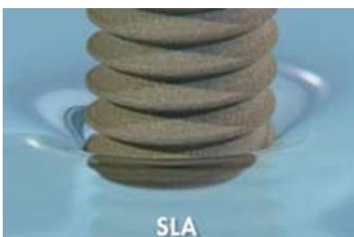
Abb. 3: Das Eintauchen von SLA- und SLActive-Implantaten in Wasser verdeutlicht die Benetzung von SLActive und seinem Wulstrand an der Kontaktfläche zwischen Wasser und Luft.
